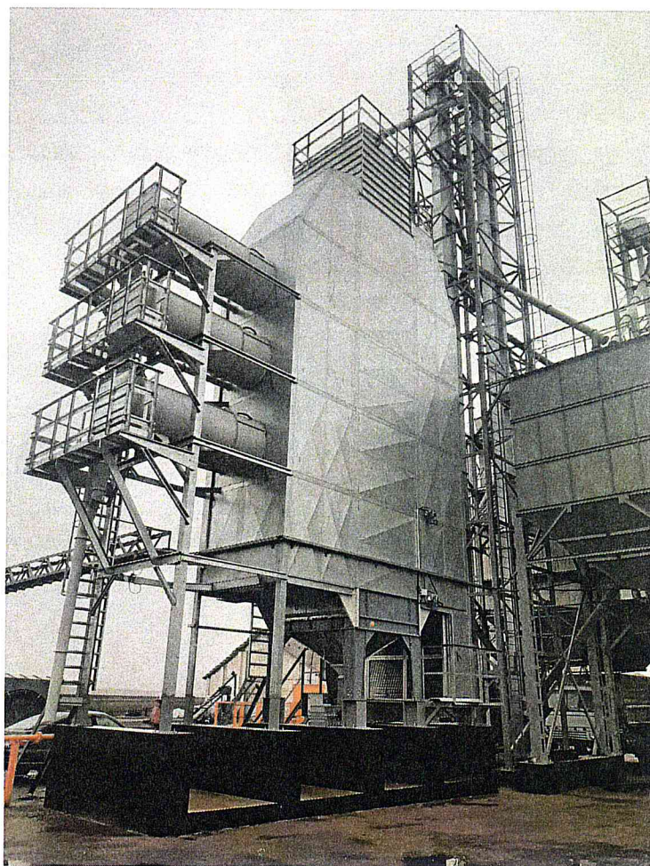
Рисунок 1. Зерносушилка модульная жалюзийная модель FLATUM 5-8 (общий вид).
