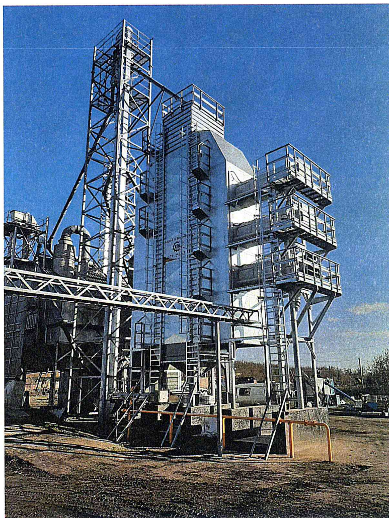
Рисунок 2. Зерносушилка модульная жалюзийная модель FLATUM 5-8 в работе в составе технологической линии.
