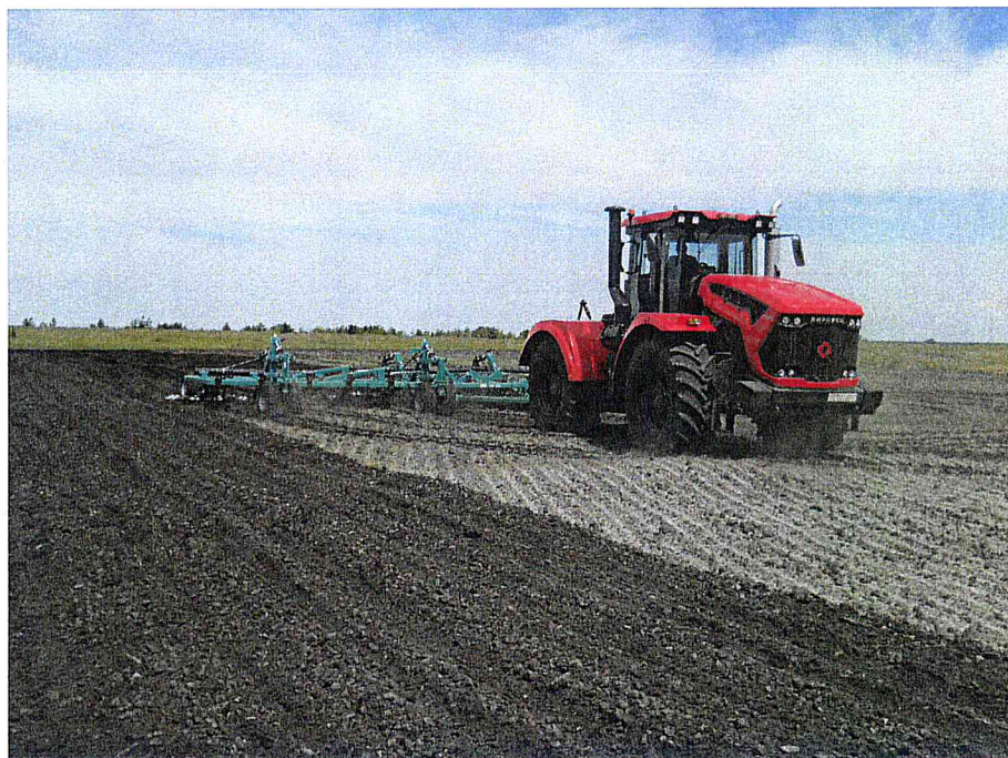
Рисунок 2 – Культиватор «Кузбасс» К-12,2 в агрегате с трактором Кировец К-739МСт1 в работе.
