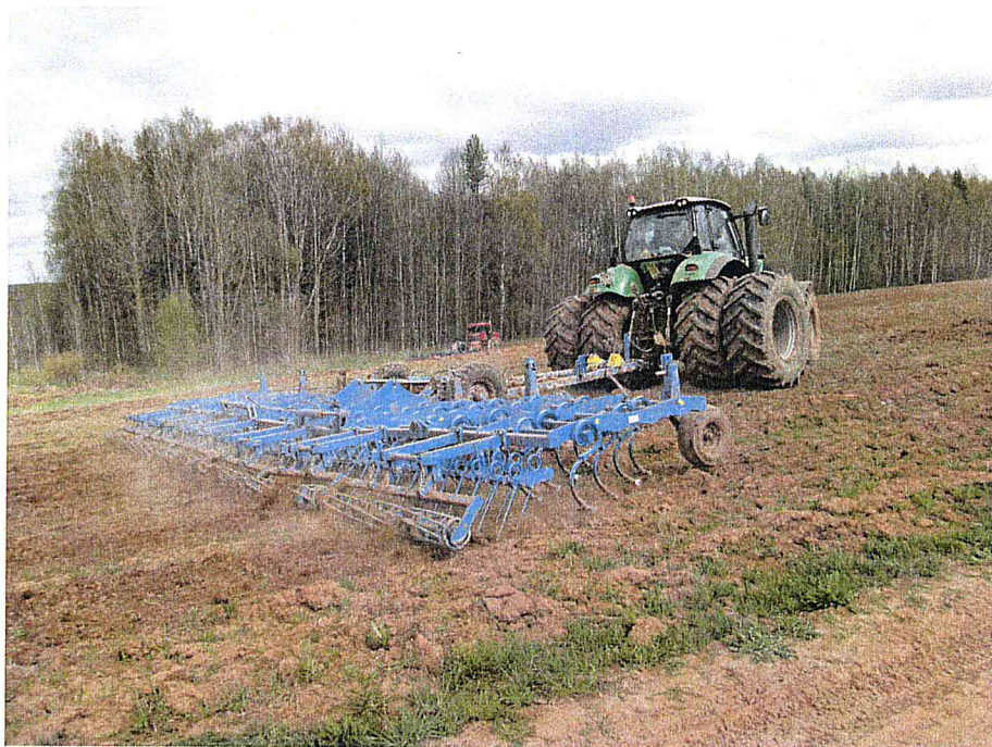
Рисунок 2 — Культиватор полуприцепной KBM-11-4П-Ш1К-ВС в агрегате с трактором Agrotion X720 в работе.
