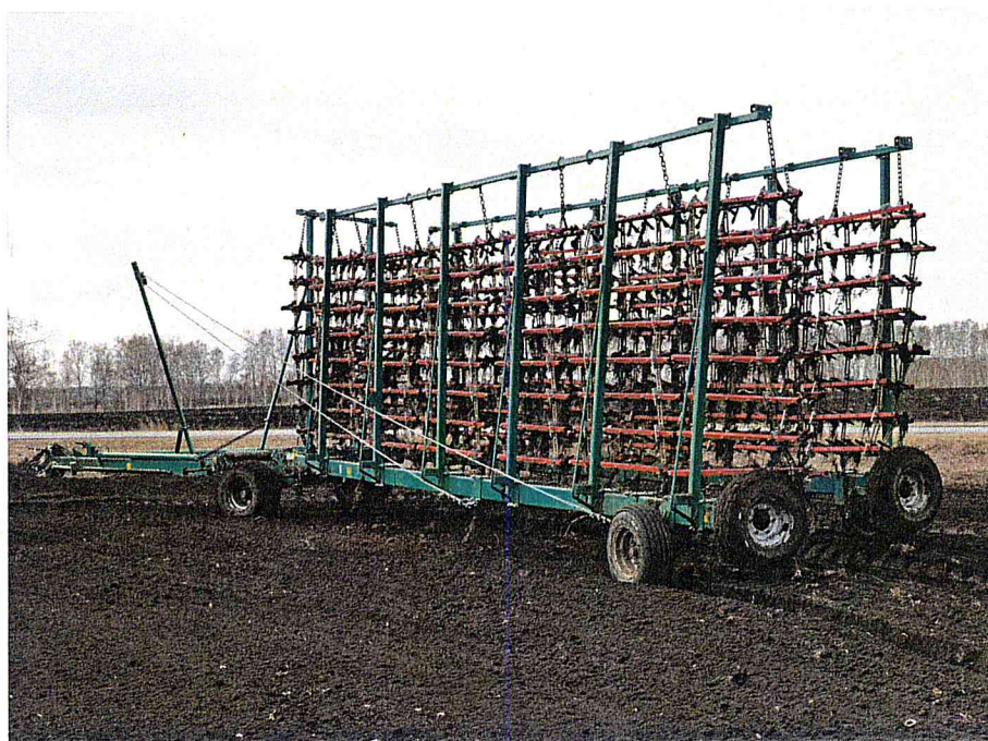
Рисунок 1 – Борона гидрофицированная универсальная БГУ-20-Ш «Кузбасс» (вид сзади).
