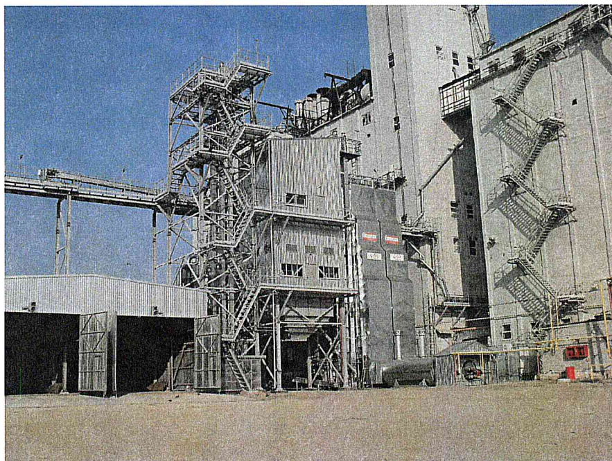
Рисунок 2 – Сушилка зерновая шахтная модульная типа «С» С-50 «Стандарт» с косвенным типом нагрева, вид топлива: газ в работе в составе технологической линии элеватора.
