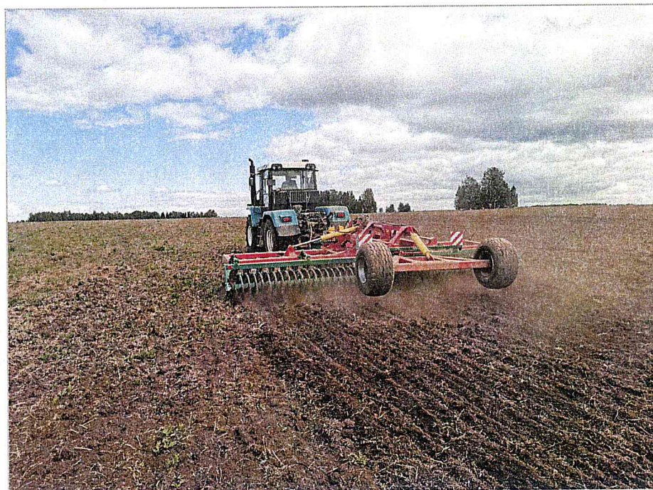
Рисунок 2 – Борона дисковая модернизированной марки «Диас» БДМ-6×2-Б-ПК-Д-ШКС в работе.
