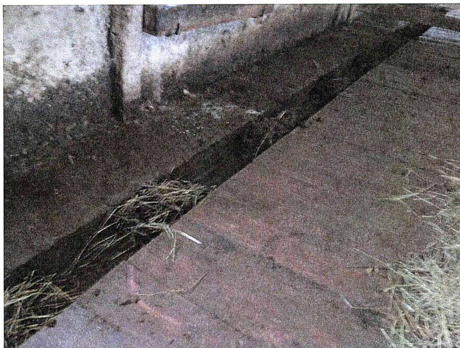
Рисунок 2. Транспортёр скребковый для навоза ТСН-3,0В в работе (горизонтальная часть).
