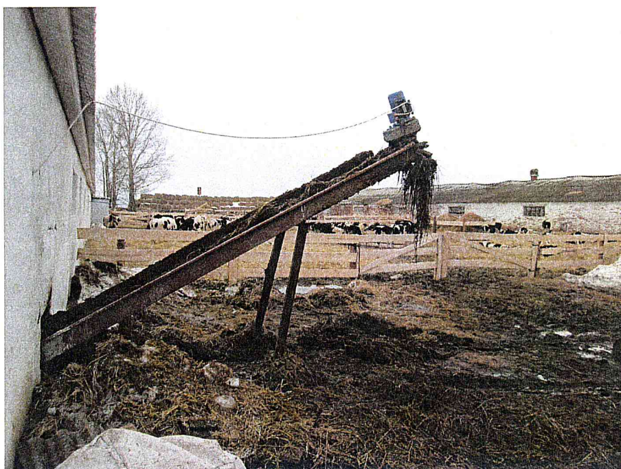
Рисунок 3. Транспортёр скребковый для навоза ТСН-3,0В в работе (наклонная часть).
