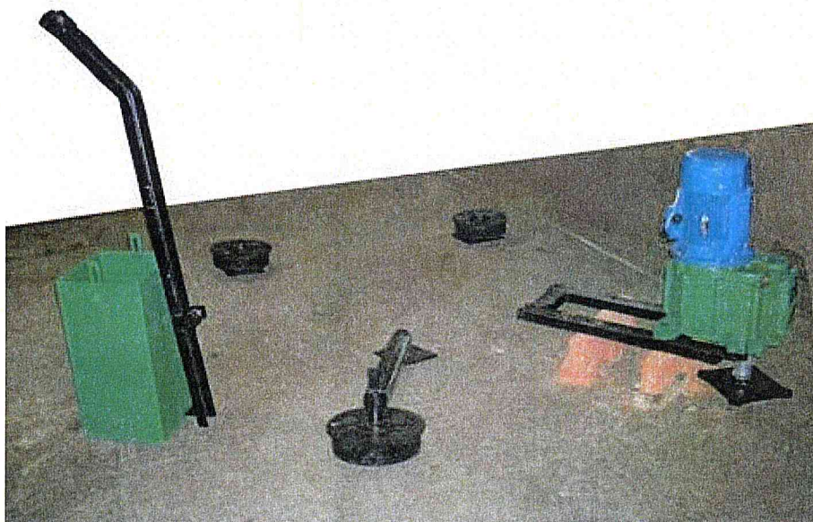
Рисунок 2. Элементы транспортера горизонтального КСН-Ф-100 (без цепи).
