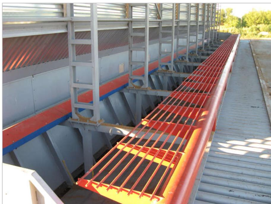
**Аэрируемый приёмник влажного зерна АПВЗ-100**
