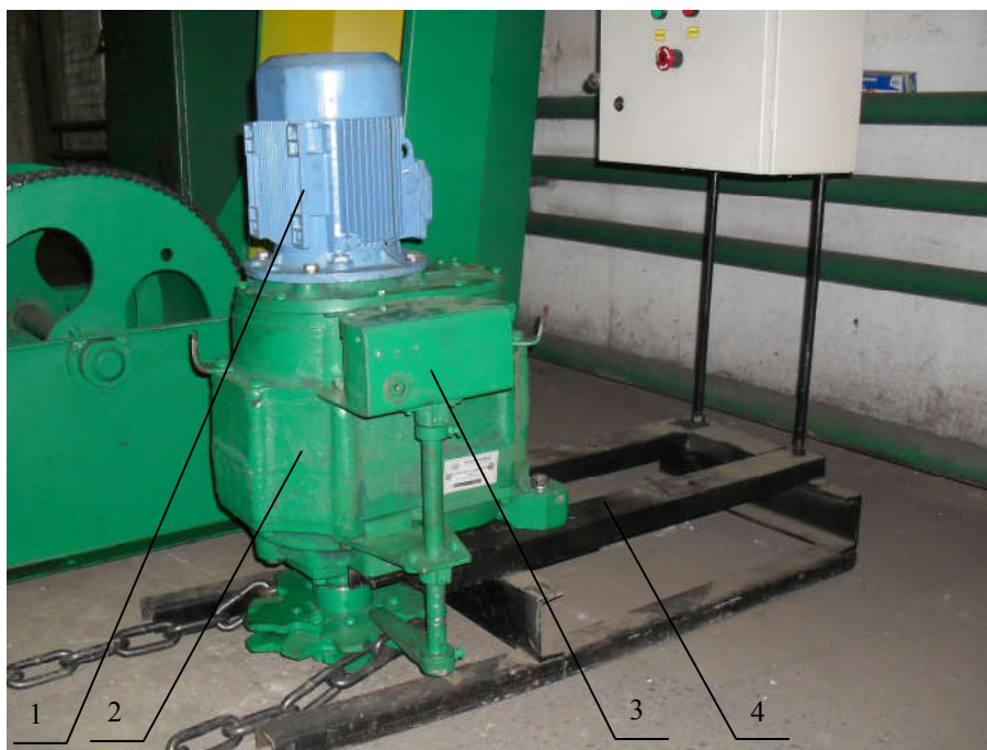
Рисунок 1 – Привод установки УНС-1 с механизмом реверса: 1 – электродвигатель; 2 – редуктор; 3 – механизм реверса; 4 – рама.
