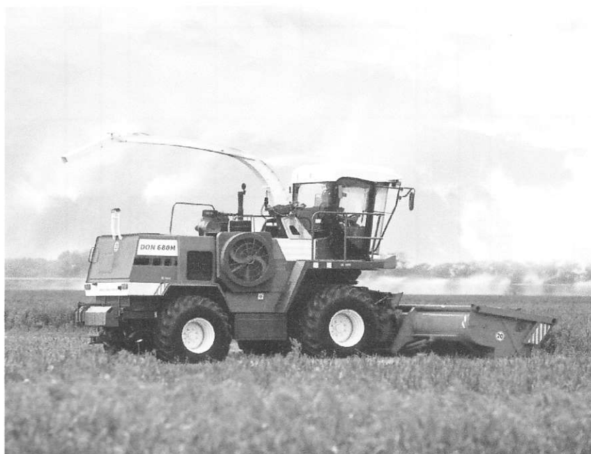
Рисунок 1 – Комбайн самоходный кормоуборочный РСМ-100 «ДОН-680М».
