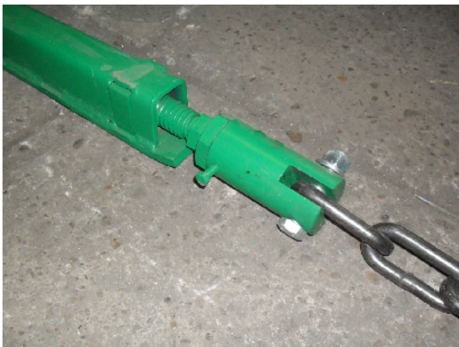
Рисунок 2 – Части цепного контура: 1 – ползун; 2 – натяжное устройство; 3 – цепь.
